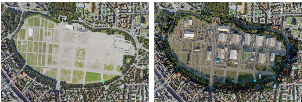
links 3D-Modell aus Flugzeugbefliegung 2021; rechts 3D-Modell aus Drohnenbefliegung 2022 innen und Flugzeugbefliegung 2021 außen ergibt die Fresh Map zur Wiesn 2022
