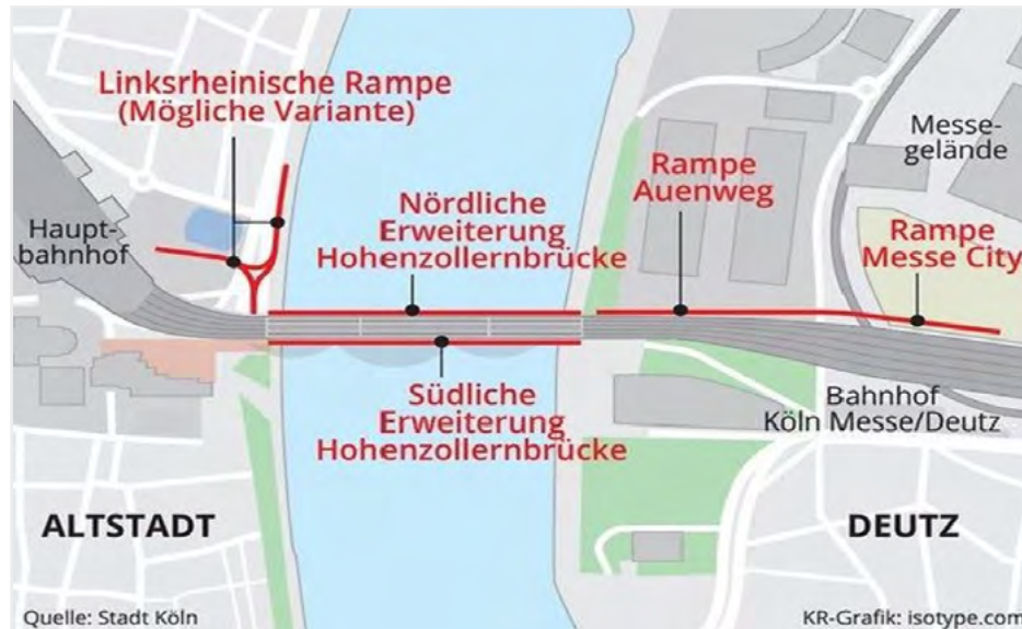
Visualisierung der Erweiterungs- und Erneuerungsbereiche der Hohenzollernbrücke
