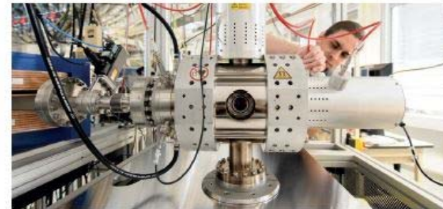
Mit dem Ionenbeschleuniger können die Physiker der Universität Duisburg-Essen die Bestandteile von Materialien prüfen oder winzige Löcher in Gewebe schießen – beispielsweise zur Weiterentwicklung von Wasserfiltern.
